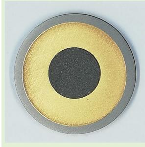
**Cr pellet:**  $\varnothing 10 \text{ mm} \times 430 \mu\text{m}$ ;  $\rho_{\text{Cr}} \sim 66\%$  bulk
