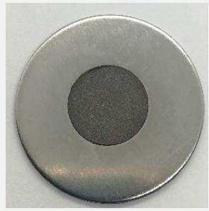
**Cr pellet:**  $\varnothing 10 \text{ mm} \times 400 \mu\text{m}$ ;  $\rho_{\text{Cr}} \sim 50\%$  bulk
