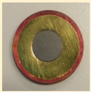
**Cr pellet:** Ø10 mm x 410 µm;  $\rho_{\text{Cr}} \sim 90\%$  bulk
