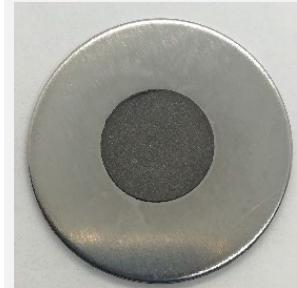
**Cr pellet:**  $\varnothing 10 \text{ mm} \times 400 \mu\text{m}$ ;  $\rho_{\text{Cr}} \sim 50\%$  bulk
